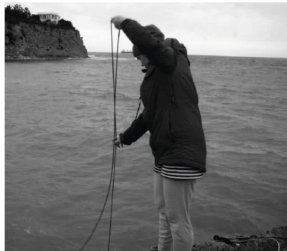
**Использование океанологического зонда для измерения температуры, давления, электропроводности воды**
