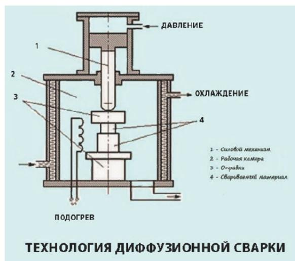
ТЕХНОЛОГИЯ ДИФФУЗИОННОЙ СВАРКИ
